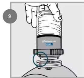
Alinhe o pino do VISIO EP Módulo com o entalhe de Base VISIO EP.
