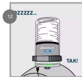
VISIO EP inicializa, pisca cada cor e faz uma expulsão. Luzes verdes confirme a operação normal.
