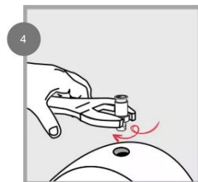
4 Aparafuse o encaixe BSP 1/8 ponto de lubrificação.
