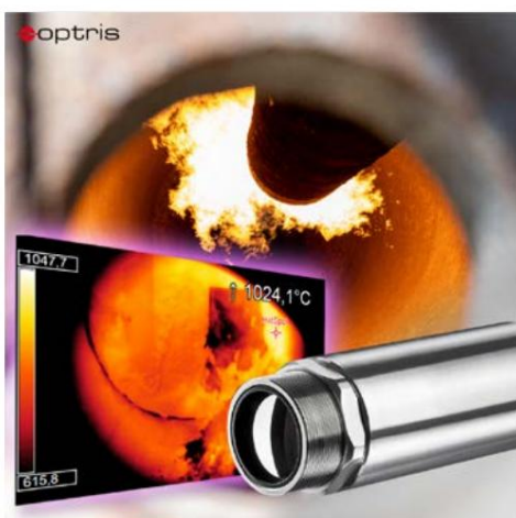
Câmera infravermelha Xi 410 MT medindo através de chamas dentro de uma fornalha
